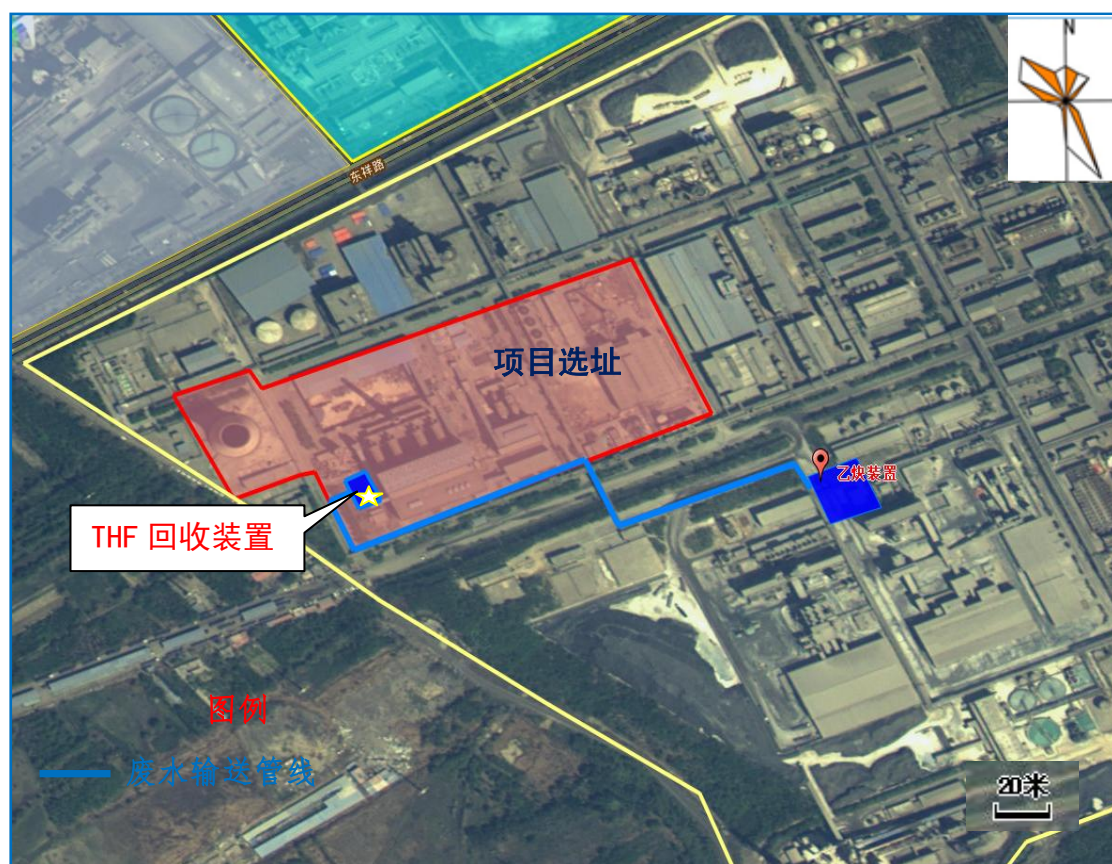
图 6.2-4 废水输送管线图
